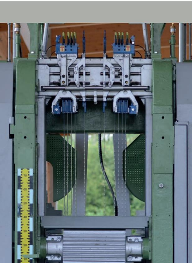
Zwei Sägenpakete und zwei Verstellsägen auf vier unabhängigen Verstellspindeln ermöglichen ein schnelles Umschalten zwischen Scharfschnitt und ein-, zwei- oder dreistieligem Schnitt.
