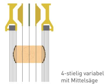
Die Schnittbilder werden gespeichert und können über das Bedienpanel mit Touchfunktion vom Bedienstuhl aus angewählt werden. Das Verstellen der Sägenpakete ist während des Gatterlaufes vom Bedienstand aus möglich.
